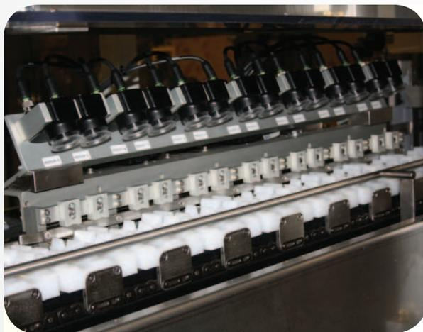
Checker 視覺感測器設定簡單、安裝容易，並以極符合成本效益的方式，提供檢測解決方案，以取代不可靠的傳統檢測器，以及非常昂貴的完全成熟視覺系統。
